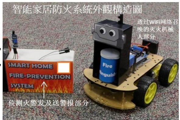
當家中發生火警時，該系統會立即開啟警鐘，然後透過網絡發出訊息予屋主的手機，屋主便可透過手機召喚滅火機械人根據指示，按預先編定的路線前往火場噴灑滅火劑。
